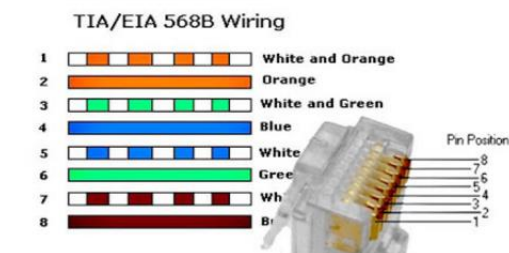
Figur 6: Ved standard 568B benyttes grøn (6) til MODBUS + og grøn/hvid(3) til MODBUS –
