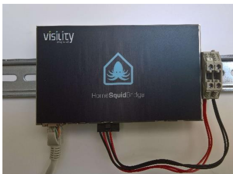
Figur 5: Visility HSB tilsluttet klemrækker i tavle.
