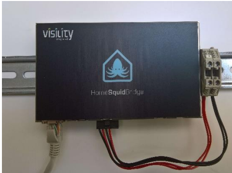
Visility HSB tilsluttet klemrækker i tavle.
