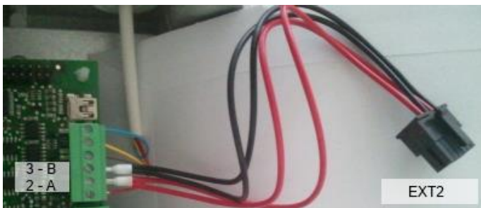
Tilslutning af Nilan Modbus på 2 forskellige anlæg. A skal til rød, B til sort.
